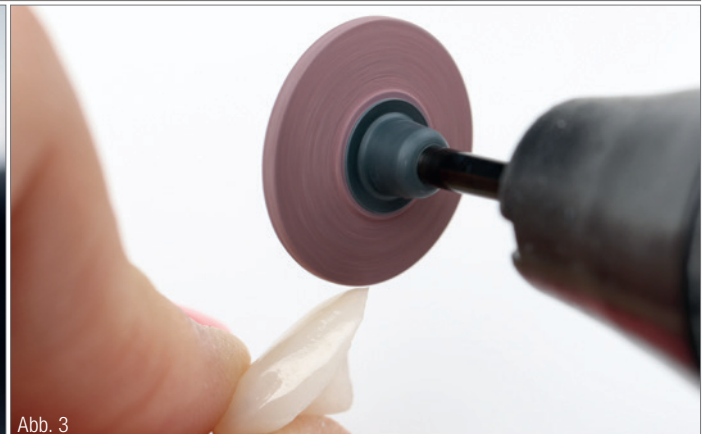
Abb. 1: Panther Stone CI050/Cone zur Ausarbeitung interdentaler Zonen. Abb. 2: Gezieltes Einschleifen funktioneller Führungsflächen mit dem Panther Stone Wh120/Wheel. Abb. 3: Messerscharfe Ränder bei besonders grazilen Elementen mit dem Panther Edition Lense 260 Smooth.
