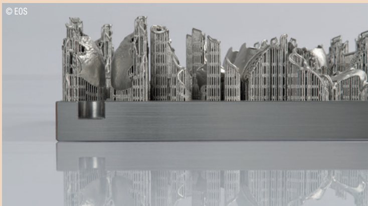
Bauplatzform mit additiv gefertigten Modellgussprothesen.
