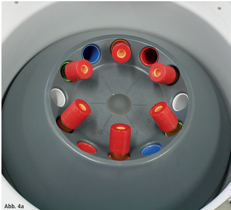
Abb. 4: PRF wird durch die Zentrifugation des venösen Blutes mittels eines genauen Protokolls hergestellt. a) Einbringen der Blutentnahmeröhrchen in die Zentrifuge – die Röhrchen müssen so angeordnet werden, dass die Zentrifuge ausbalanciert bleibt. b) PRF-Röhrchen nach Zentrifugation – drei Phasen sind abgrenzbar: azelluläres Plasma, Fibringerüst, Erythrozyten. c) PRF-Koagel nach der Abtrennung von dem Blutkörperchen-Koagel.
