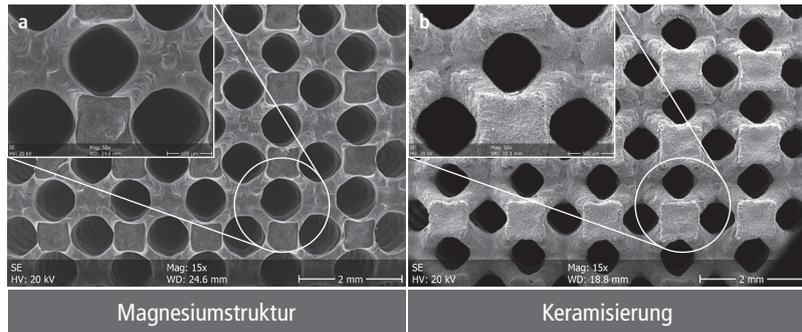
**Abb. 1:** Prototyp eines resorbierbaren, individuellen Magnesiumimplantats für größere Knochen-defekte ohne Keramisierung (a) und nach erfolgter Keramisierung (b).
