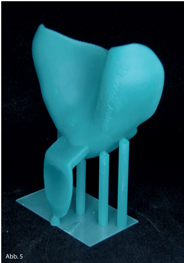
Abb. 5: Löffel auf Bauplattform. Abb. 6: Passung des Provisoriums (FREEPRINT® temp). Abb. 7: Nahaufnahme Passungskontrolle des NEM-Gerüsts der definitiven Arbeit.
