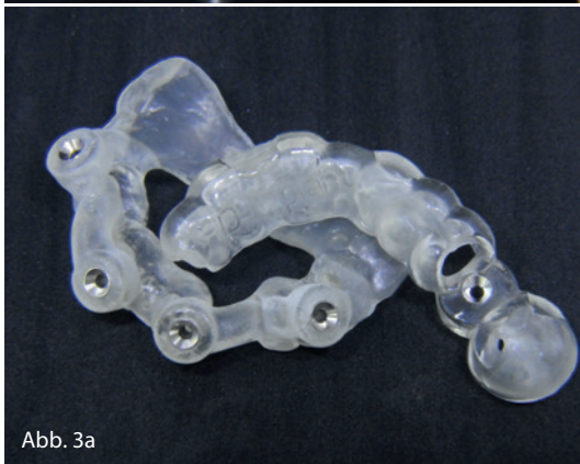
Abb. 2a: Printjob Zahnfleischmaske (FREEPRINT® gingiva) direkt auf Bauplattform. Abb. 2b: Fertiges Implantatmodell mit abnehmbarer Zahnfleischmaske. Abb. 3a und b: Bohrschablonen mit FREEPRINT® ortho.
