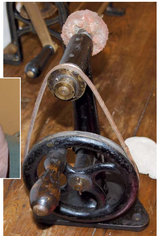
Abb.2: Mangels Gussmaschine griffen Zahntechniker vor 140 Jahren auf den Kartoffeldruck zurück. – Abb.3: Die historische Poliermaschine.
