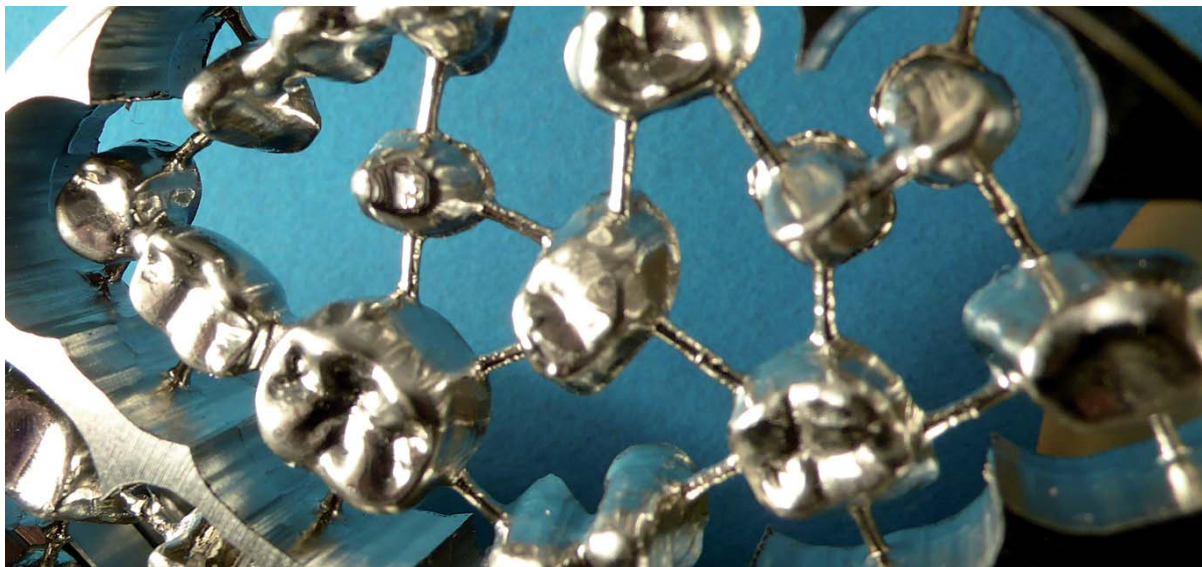
Abb. 2: Effektive Bearbeitung des Materials bis zum Rand durch Radialspannung.
