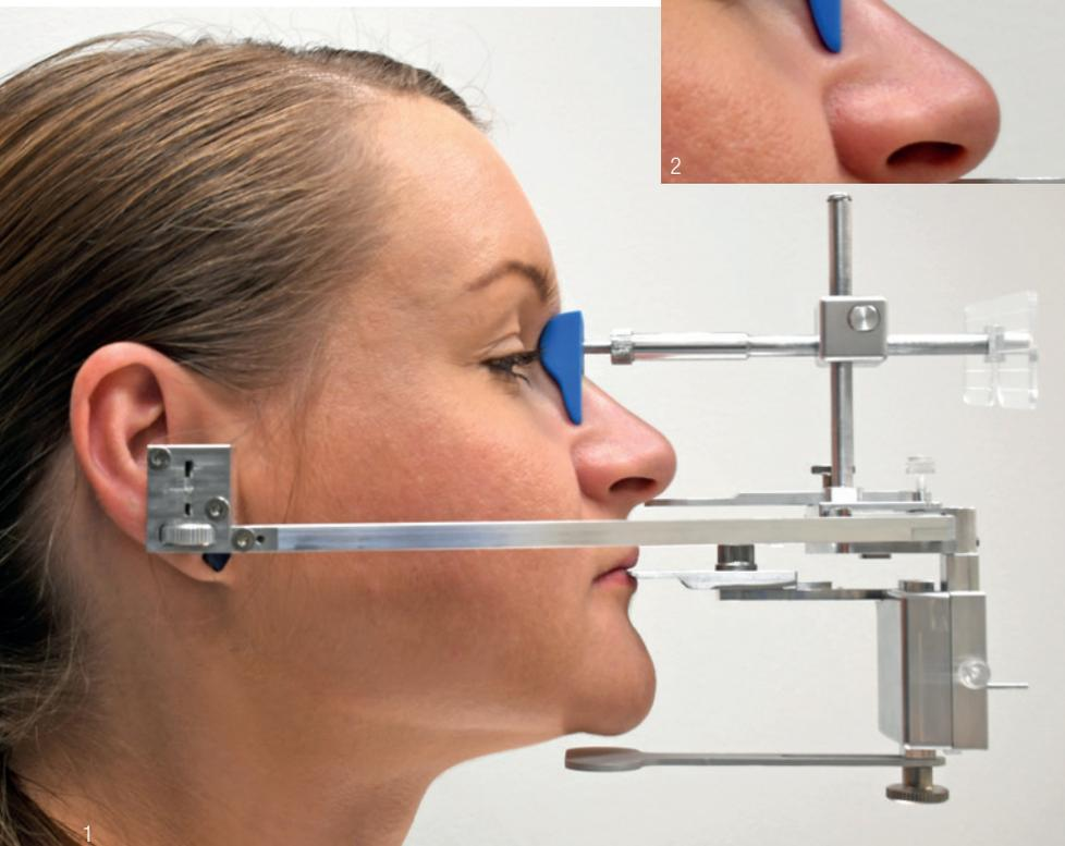
**Abb. 1:** therafaceline – das neue Gesichtsbogen-system in situ. **Abb. 2:** Ansicht der Nasenstütze inklusive des Bipupillarlineals. Die Nasenstütze kann zudem vertikal nach der Camperschen Ebene und der Patientenhorizontalen ausgerichtet werden.
