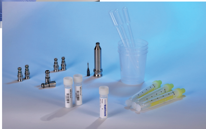
Zur Routinekontrolle der Reinigungsleistung können Übertragungsinstrumente unter Verwendung verschiedener Adapter überprüft werden.
