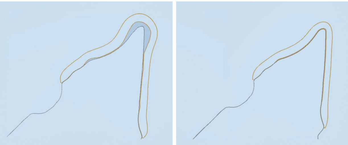
Abb. 1: Schaubild Fräserradius: links gefräst; rechts LaserMelting. Abb. 2: GOLD-Gerüst aus dem LaserMelting-Verfahren.
