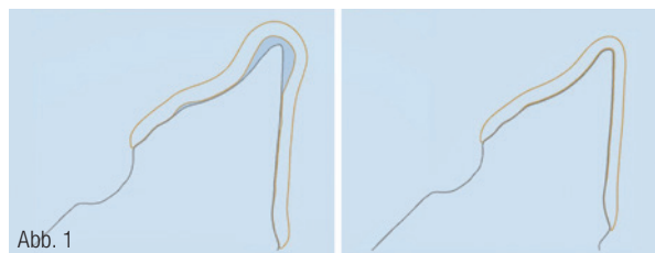
Abb. 1: Schaubild Fräserradius: links gefräst; rechts LaserMelting. Abb. 2: GOLD im LaserMelting-Verfahren.
