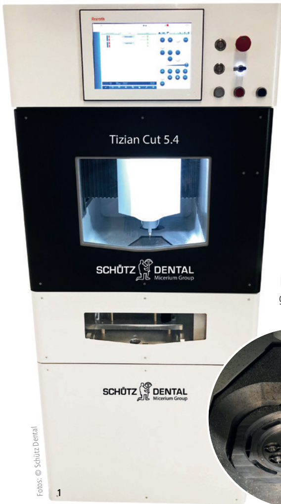
Abb. 1: Wirtschaftlich produzieren: Mit der Tizian Cut 5.4 ist es Unternehmen in der digitalen Dentalwelt möglich, produktivere Frässtrategien zu fahren. – Abb. 2: Integrierter taktile Messtaster zur automatischen Kalibrierung vor dem Fräsen von präfabrizierten Abutments oder Glaskeramik.
