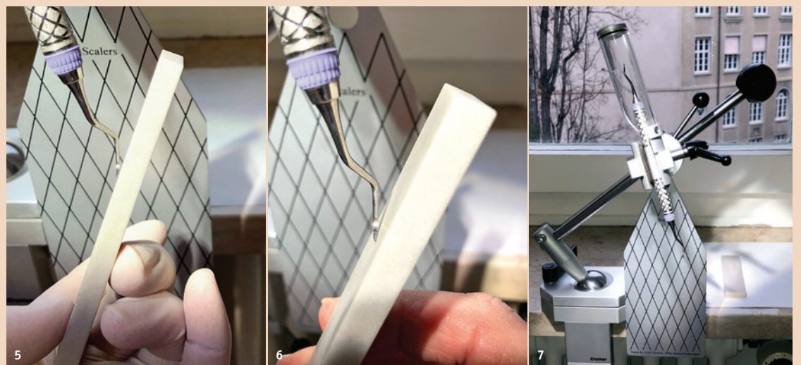
Abb. 5 und 6: Der Stein wird nach dem Ausrichten mit leichtem Druck von oben nach unten bewegt. Wenige Bewegungen reichen für ein optimales Resultat. – Abb. 7: Von Hand schleifen mit der Kramer-Schleifstation.
