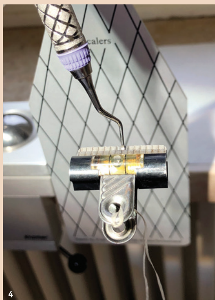
Abb. 4: Die «Libelle» zum Ausrichten des Instrumentes und die Schablone, mit der der dazu passende richtige Schleifwinkel kontrolliert werden kann.
