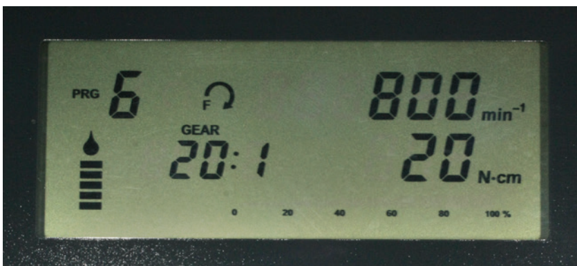
Abb. 3: Einstellung Chirurgiemotor für Sofortimplantation mit BLX.
