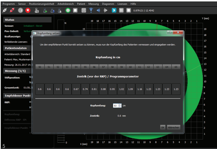
Abb. 4: Messbild eines DIR® Registrates mit visualisierten Bewegungsbahnen. Die Seitenschkel stellen die beiden Laterotrusionsbahnen des Stützstiftes dar, wogegen die mittleren Kurven die Protusionsbahnen repräsentieren. Die Verschlüsselungsposition der Registrierschablonen entspricht der Zentrikposition (ZKP) und liegt in Abhängigkeit vom Kopfumfang des Patienten zwischen 0,6 und 1,23 mm vor der Pfeilspitze an der Schnittstelle der beiden Seitenschkel, die der RKP bzw. der maximal retralen Kondylenposition entspricht (Abb. 5). Abb. 5: Korrelation zwischen Kopfumfang des Patienten und Abstand zwischen RKP und ZKP.
