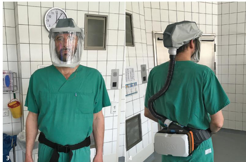
der Haube herrscht permanent leichter Überdruck. Dadurch werden keine eng anliegenden Dichtlippen wie bei Vollmasken benötigt. Vielmehr verhindert die am Rand kontinuierlich austretende Luft ein Eindringen von Schadstoffen. Die Atemluft muss vom Träger nicht aktiv angesaugt werden. Dadurch besteht kein erhöhter Atemwiderstand. Durch das Einblasen der Luft über den Kopf ist auch hier ein Beschlagen des Visieres praktisch unmöglich. Unter der
