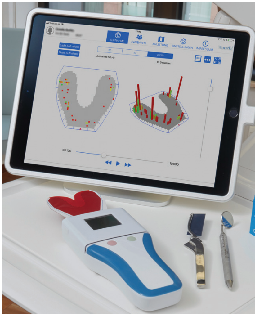
Abb. 1: OccluSense mit Sensor, Handgerät und iPad.
