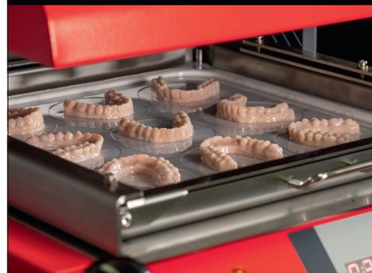
Das Ergebnis: Bis zu 9 Schienen in einem Tiefziehvorgang in identischer Qualität. Das ergibt bis zu 108 Schienen pro Stunde – mit 1 Mitarbeiter!
