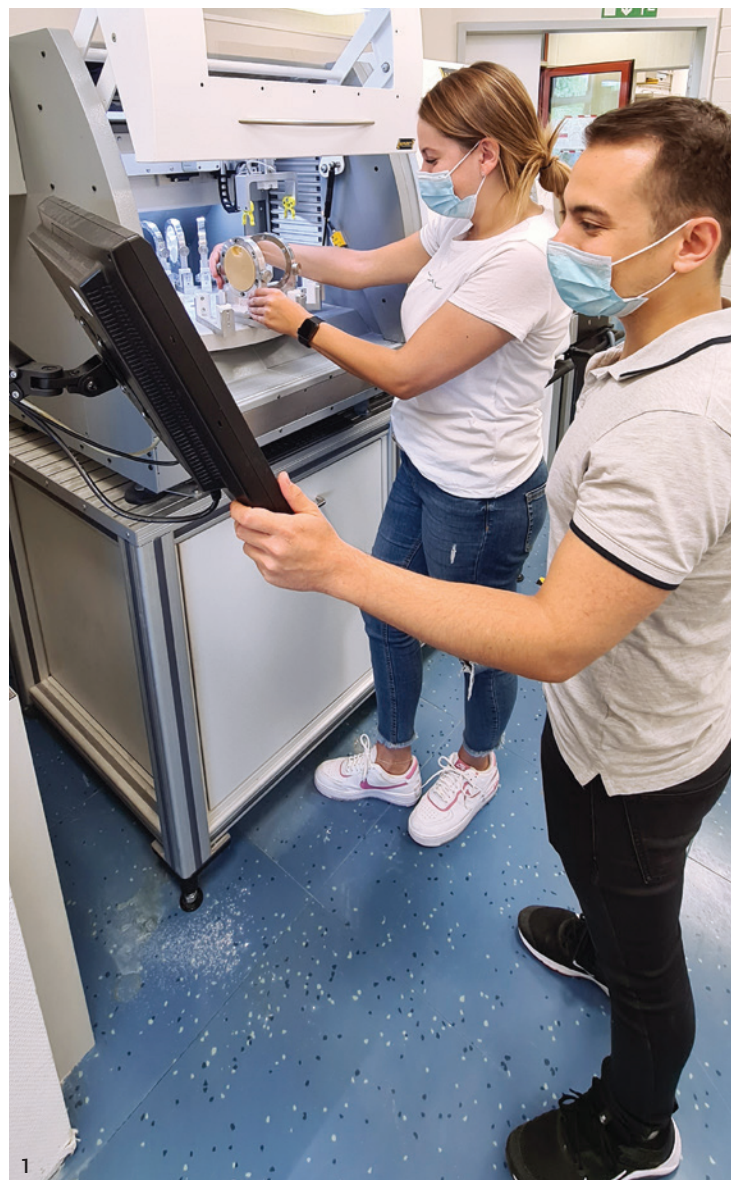
Abb. 1: Benjamin Jaino und Fabienne Wischniowski, Meisterschüler im aktuellen Kurs, bereiten die Maschine Imes 450i zum Fräsen von Wachsteilen vor. Abb. 2: Übungen im 3Shape.
