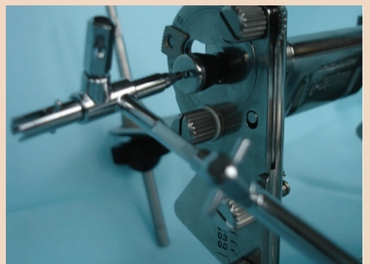
Abb. 2: Gerber Condylator mit Gerber Dynamic Facebow im Detail.
