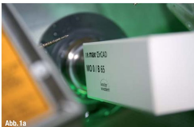
▲ Abb. 1a: Zirkonoxidblock in der Schleifmaschine. ▲ Abb. 1b: Materialvielfalt von Zirkon bis Glaskeramik.
