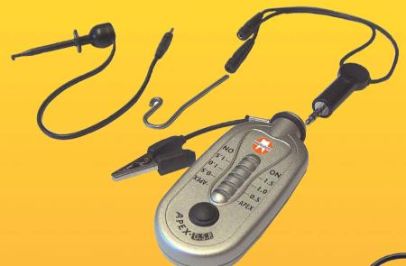
Die Präzision übertrifft ältere Geräte und lokalisiert den Apex bei allen Kanalbedingungen, einschliesslich trockenen, feuchten und blutenden Kanälen.
