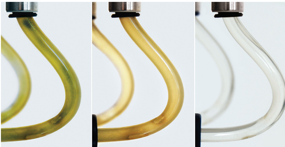
Abb. 1: Das SAFEWATER Hygiene-Technologie-Konzept baut bestehende Biofilme ab und schützt vor deren Neubildung.
