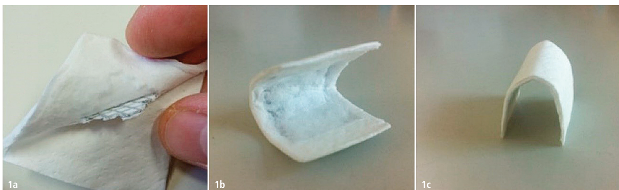
Abb. 1: Aufbau der innovativen volumenstabilen Barrieremembran. a) Integration des Magnesiumnetzes in die Kollagenmembran. b und c) Formbarkeit und Volumenstabilität der Kollagenmembran mit dem integrierten Magnesiumnetz.
