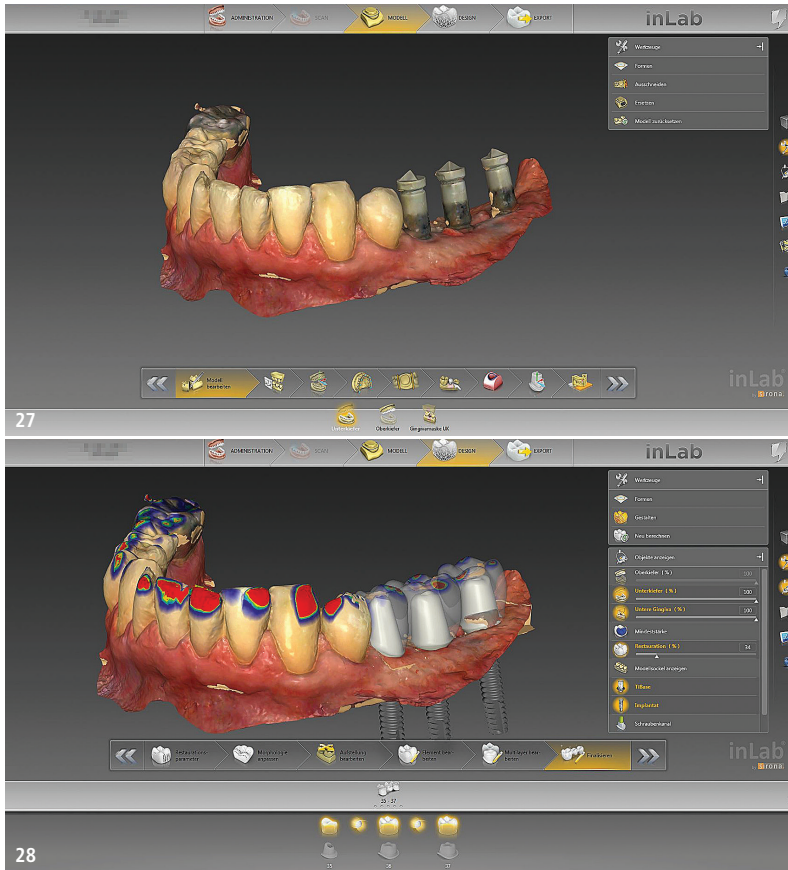
Abb. 27 und 28: Konstruktion nach 3D-Scan.
