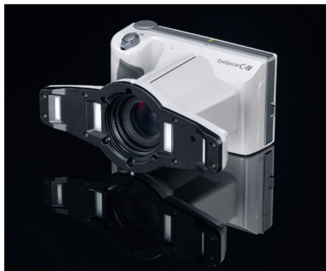
Chroma, interne Lichteffekte und individuelle Zahncharakteristika werden sichtbar, ohne dass durch den Schmelz erzeugte Lichtreflexionen diese verfälschen. Auch farbliche Effekte des Hart- und Weichgewebes lassen sich mit Polfilter besser beurteilen.
