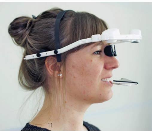
Abb. 11: Der Oberkieferbogen des Tizian JMA Optic by zebris-Systems ist schnell und einfach aufzusetzen. Mit 15 g ist der Unterkieferbogen sehr leicht und gut zu handhaben. Durch eine systemeigene stabile WLAN-Verbindung zum PC entfallen störende Kabel. Abb. 12: Der Oberkieferbogen ermöglicht der Patientin einen sicheren Halt und eine gute Sicht. Abb. 13: Eingesetzter, im Labor gedruckter Kopplungsöffel.
