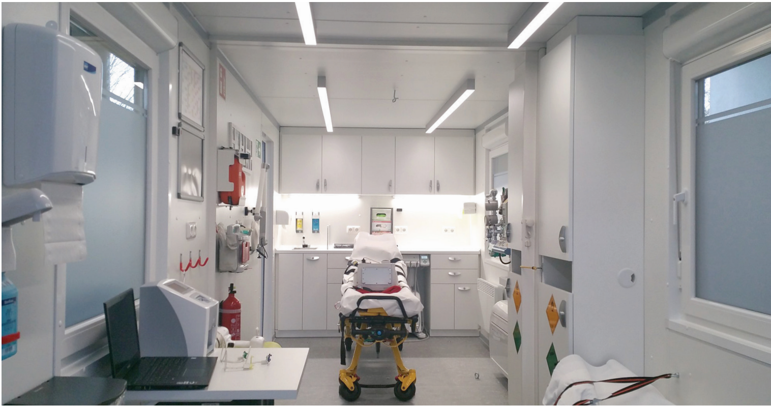
Ein absolutes Unikat: Das Zahnmobil hat eine zahnärztliche Behandlungseinheit, mobile Tragesysteme aus dem Rettungsdienst und Beatmungs- und Narkosegeräte aus der Luftrettung. Es basiert auf dem Container-Prinzip der Bundeswehr, wobei die Einzelkomponenten auf dem Markt zur Verfügung stehen. Das Ganze aber, die Infrastruktur, ist einmalig und auf Dr. Blum und sein Team zugeschnitten.
