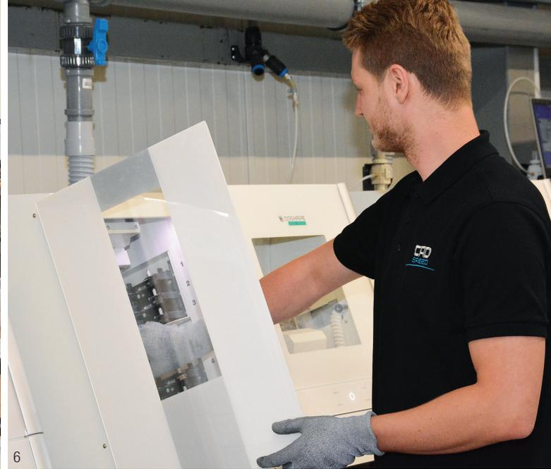
**Abb. 4:** Das Team im Bereich Computer-Aided Manufacturing (Produktion) bei CADSPEED. **Abb. 5:** Produktionsvorbereitung im CAM-Arbeitsraum. **Abb. 6:** Bestückung einer Fräseinheit DWX-52DCi mit neuen Rohlingen.
