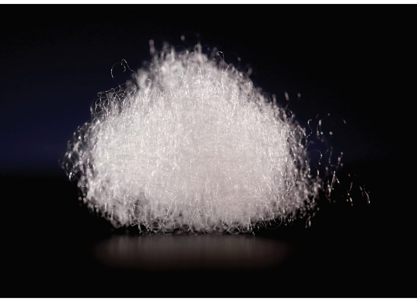
Die Fasern des neuen Isolationsmaterials bestehen zu 100 Prozent aus recyceltem Polyester. (Foto: © 3M)
