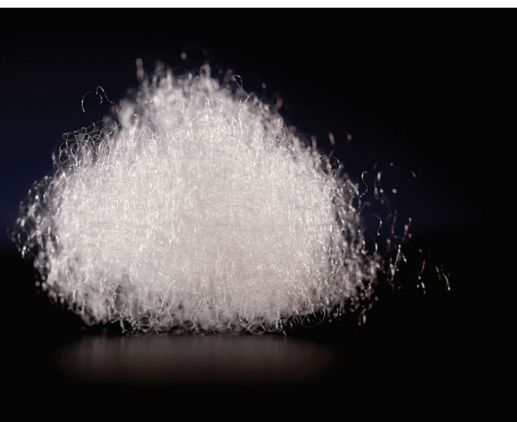
Die Fasern des neuen Isolationsmaterials bestehen zu 100 Prozent aus recyceltem Polyester. (Foto: © 3M)
