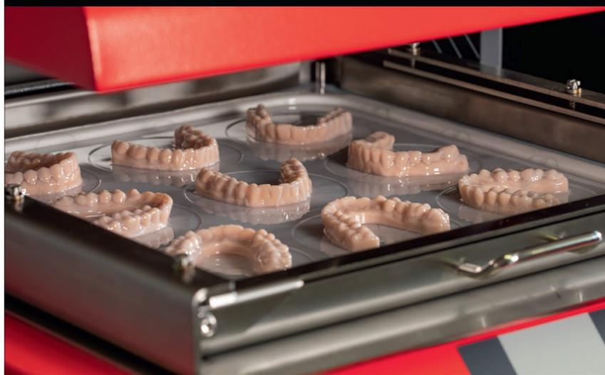
Das Ergebnis: Bis zu 9 Schienen in einem Tiefziehvorgang in identischer Qualität. Das ergibt bis zu 108 Schienen pro Stunde – mit 1 Mitarbeiter!
