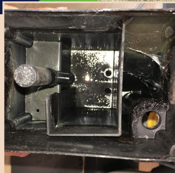
Die Wasser führenden Systeme von Zahnarztpraxen bieten Biofilmen und Wasserkeimen ideale Wachstumsvoraussetzungen – wie hier die freie Fallstrecke von Dentaleinheiten.
