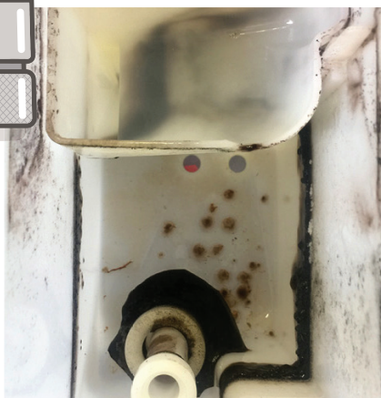
Abb. 1: Biofilme greifen die einzelnen Bestandteile der Dentaleinheiten an.
