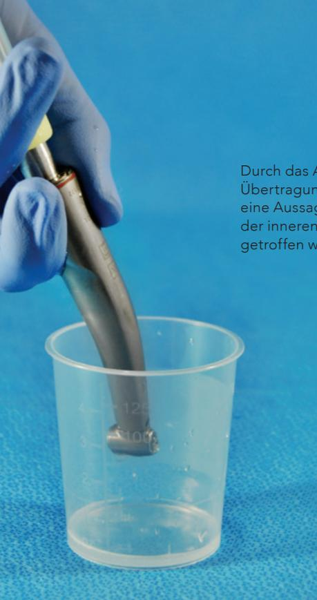
Durch das Ausspülen der Übertragungsinstrumente kann eine Aussage über die Sauberkeit der inneren Komponenten getroffen werden.
