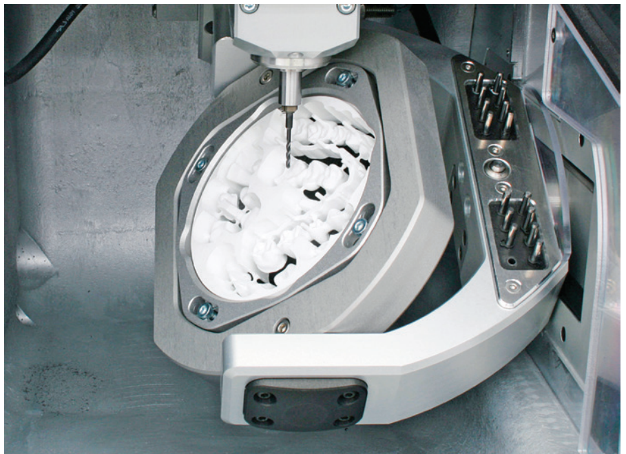
Der Innenraum einer vhf S1 bei der Bearbeitung. Mit der fünfachsiggen Fräsmaschine wurden die Prothesenproben für die Studie gefertigt.
