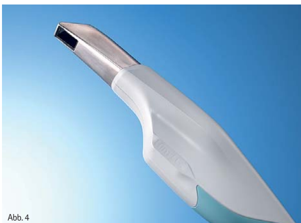
Abb. 4: In das Handstück wurden ein Projektionssystem und zwei Kameras integriert. Es weist eine Gesamtlänge von etwa 30 cm und eine Bauhöhe von circa 7 cm auf. Letztere verjüngt sich zur Aufnahmespitze hin auf 1,5 cm. – Abb. 5: Die Einzelaufnahmen werden von der Software zunächst zu einer Punktwolke gematcht.
