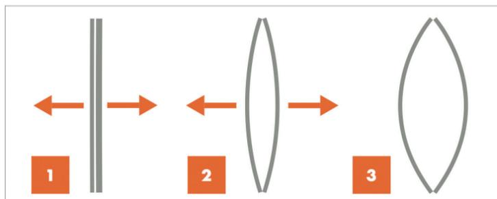
Die blätterförmigen MEMORIA®-Federn aus Nickel-Titanium werden durch Komprimierung aktiviert (1) und kehren während des Deaktivierungsprozesses in ihre ursprüngliche Form zurück (2, 3), wodurch eine kontrollierte, konstante Kraftabgabe generiert und eine kalibrierte Oberkieferexpansion erreicht wird. (Foto: © Leone)
