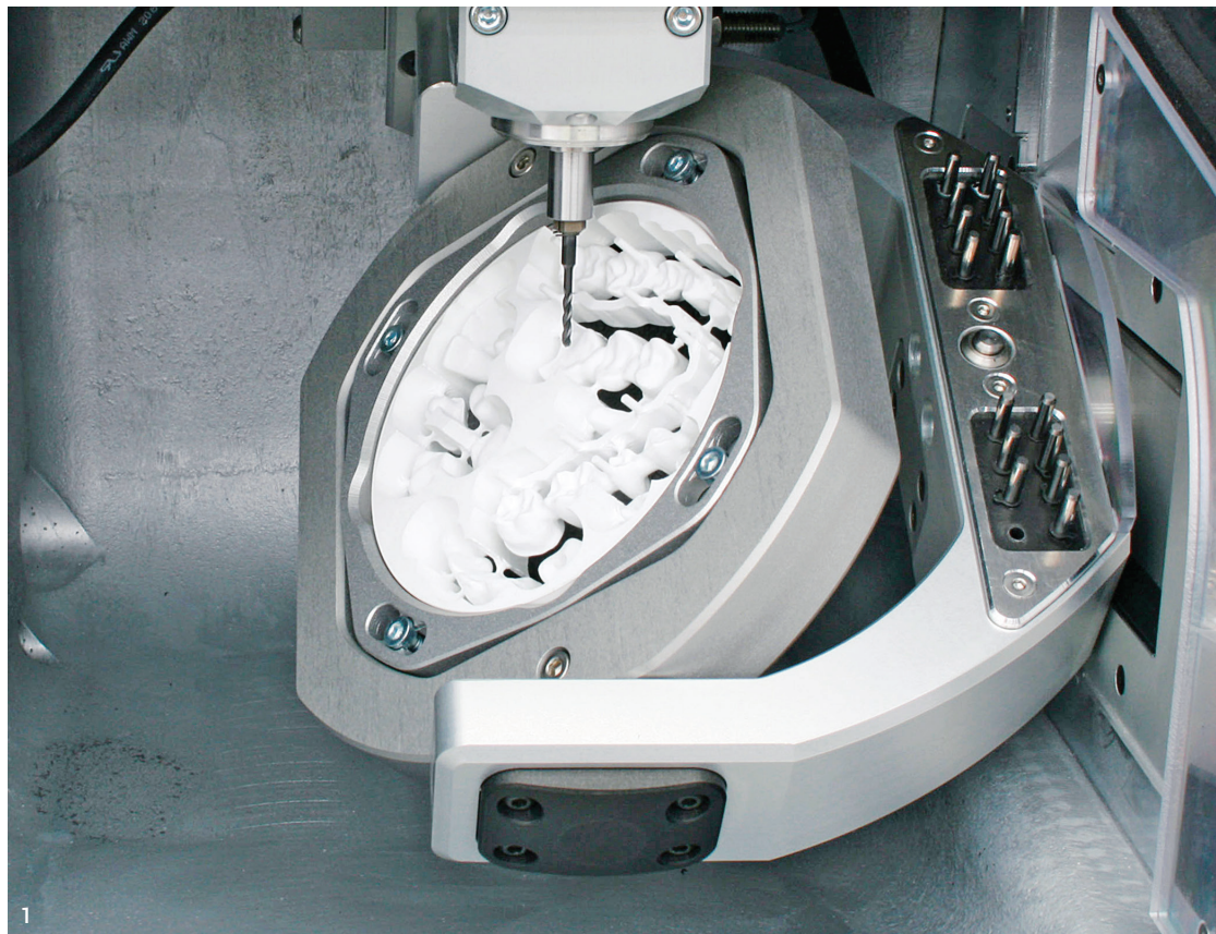
Abb. 1: Der Innenraum einer vhf S1 bei der Bearbeitung. Mit der fünfschigen Fräsmaschine wurden die Prothesenproben für die Studie gefertigt.
