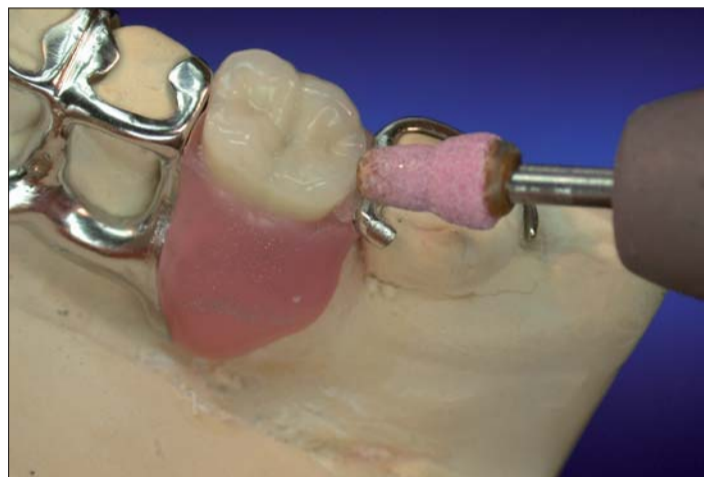
Abb. 4: Es sollte so viel defektes Gefüge weggeschliffen werden, dass man auf sauberes Gussmaterial kommt.
