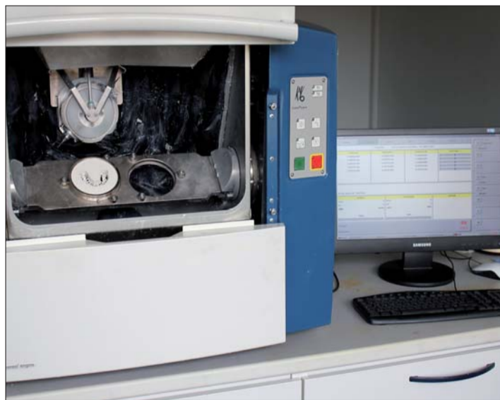
Die KaVo Everest Engine zählt für FDZ zu den besten Fräsmaschinen für den Dentalbereich. Besonders vorteilhaft sind ihre simultane Fünfachsigkeit und die Möglichkeit, Kühlschmierstoff einzusetzen.
