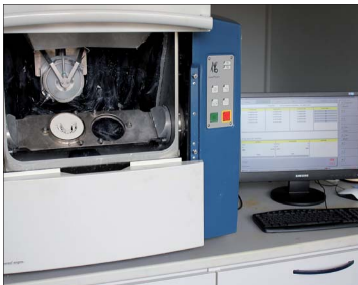
Die KaVo Everest Engine zählt für FDZ zu den besten Fräsmaschinen für den Dentalbereich. Besonders vorteilhaft sind ihre simultane Fünfachsigkeit und die Möglichkeit, Kühlschmierstoff einzusetzen.
