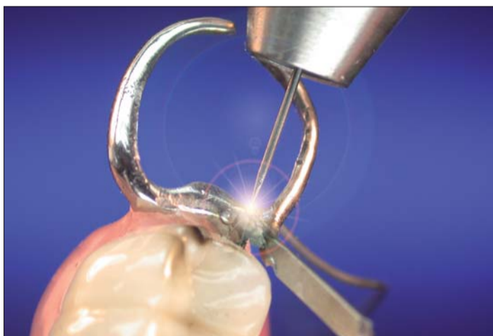
Abb. 8: Im Fall einer gebogenen Klammer sollte in dieser Phase der überstehende Teil des gebogenen Klammerarms abgetrennt werden.
