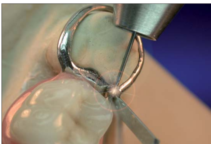
Abb. 6: Es wird immer kohlenstofffreier, gezogener Kobalt-Chrom-Draht als Zulegematerial verwendet.
