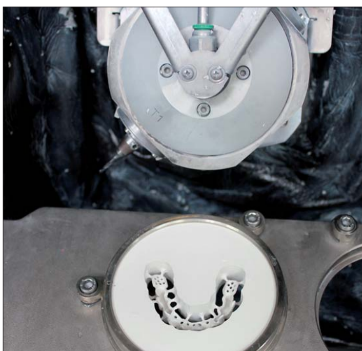
Mit WorkNC Dental programmiert und fünfachsiger gefräst – die PEEK-Ronde wird nach der Bearbeitung gereinigt, verpackt und zum Kunden geschickt.
