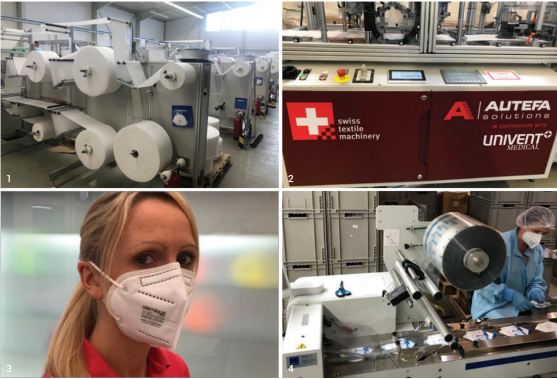
**Abb. 1:** Herstellung der Masken aus dem streng geprüften Filtermaterial Melt-blown (vierschichtige Masken). **Abb. 2:** Durch die Firma UNIVENT optimierte, vollautomatisierte Herstellung der FFP2-Masken mit Spezialmaschinen aus der Schweiz. Die acht Produktionsbahnen in der modernen Halle laufen Tag und Nacht. **Abb. 3:** Gute Passform und hohe Materialqualität machen das Tragen der Maske angenehm. **Abb. 4:** Verpacken unter hygienischen Bedingungen.
