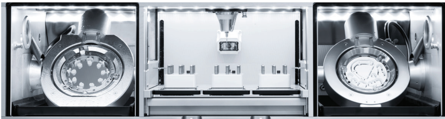
Abb. 1: Teleskoper Orbit für Blanks mit \varnothing 95, 98, 106 und 125 mm Abb. 2: Raw-Abutment®-Halte für bis zu sechs Werkstücke. Abb. 3: 125 mm Blank für bis zu vier Aufbisschienen Abb. 4: Double Milling Funktion.
