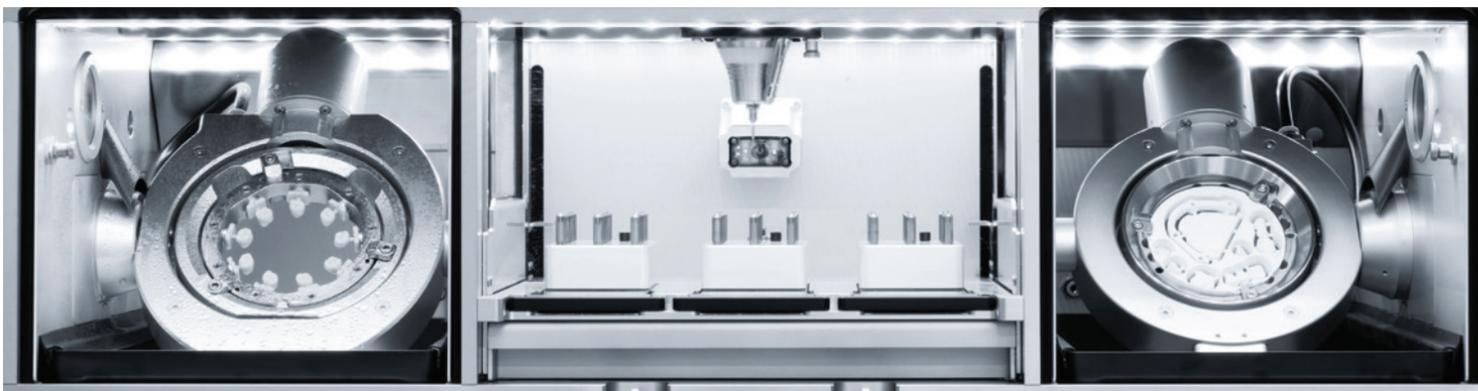
Abb. 1: Teleskoper Orbit für Blanks mit  $\varnothing$  95, 98, 106 und 125 mm Abb. 2: Raw-Abutment®-Halte für bis zu 6 Werkstücke. Abb. 3: 125 mm Blank für bis zu 4 Aufbisschienen Abb. 4: Double Milling Funktion.
