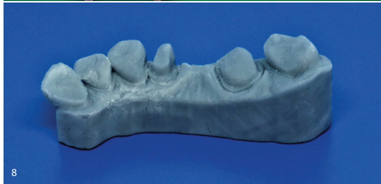
Abb. 7: Eine definitive Brücke auf dem Arbeitsmodell im FDM-Druck (80 µm Schichtdicke). Abb. 8: Ein Modell im DLP-Druck (80 µm Schichtdicke). Abb. 9: Ein Prüfkörper im DLP-Druck für die Maßhaltigkeit (80 µm Schichtdicke).
