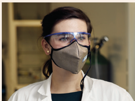
Die neuartige Maske deaktiviert Viren und Bakterien mittels einer kleinen Spannung.
