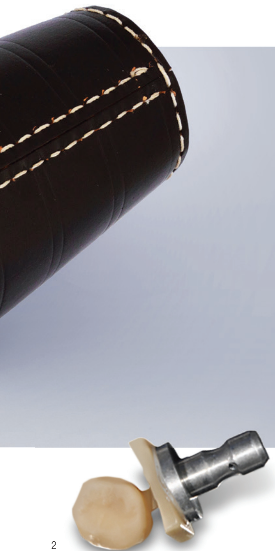
Abb. 2: Beispiel einer aus einem CAD/CAM-Block herausgefrästen Seitenzahnkrone.
